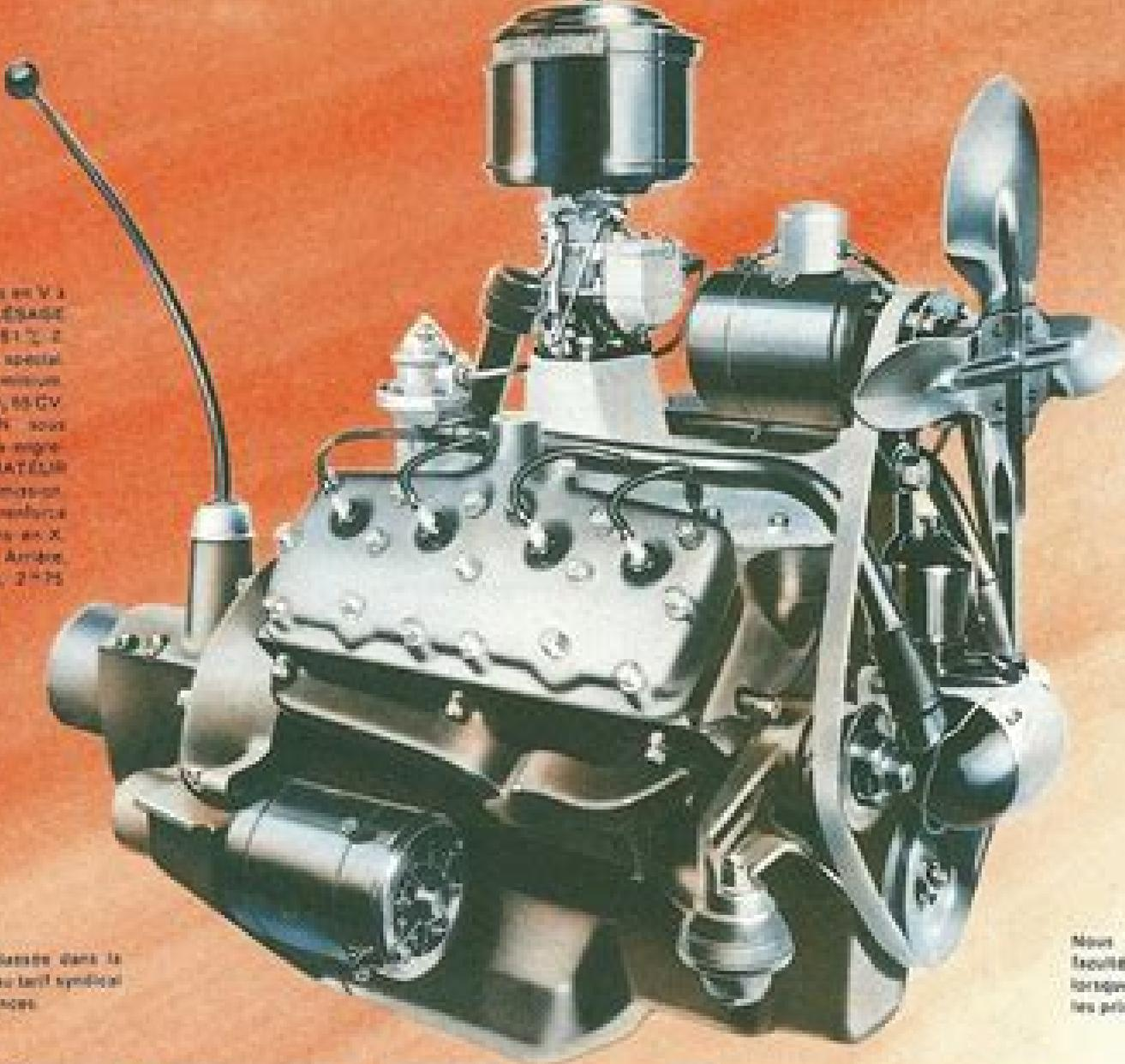
**MOTEUR**, 6 cylindres en V à 90°, Monopoint. — **ALÉSAGE** 66 mm. — **COURSE** 61,2 mm. — **PISTONS** en alliage spécial. — **CULASSES** en aluminium. — **PUISSANCE** au frein, 55 CV. — **LUBRIFICATION** sous pression par pompe à engrenages. — **CARBURATEUR** inversé à double admission. — **CHASSIS** en acier renforcé par douvres latérales en X. — **Vois** : Avant, 1742, Arrière, 1746. — **Encastrement**, 2175.
