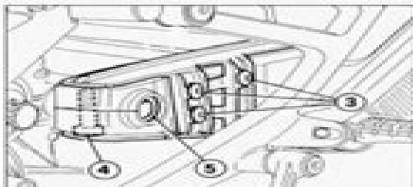
Estrarre i tappi in plastica in corrispondenza del fulcro del forcellone da entrambi i lati. Svitare le viti (3) di fissaggio del pattino catena e rimuovere quest'ultimo dal forcellone. Allentare le viti (4) di fissaggio sui morsetti di serraggio del perno forcellone. Utilizzando una spina adatta spingere in fuori il perno (5) forcellone dal lato sinistro fino a metà circa della sua lunghezza.
