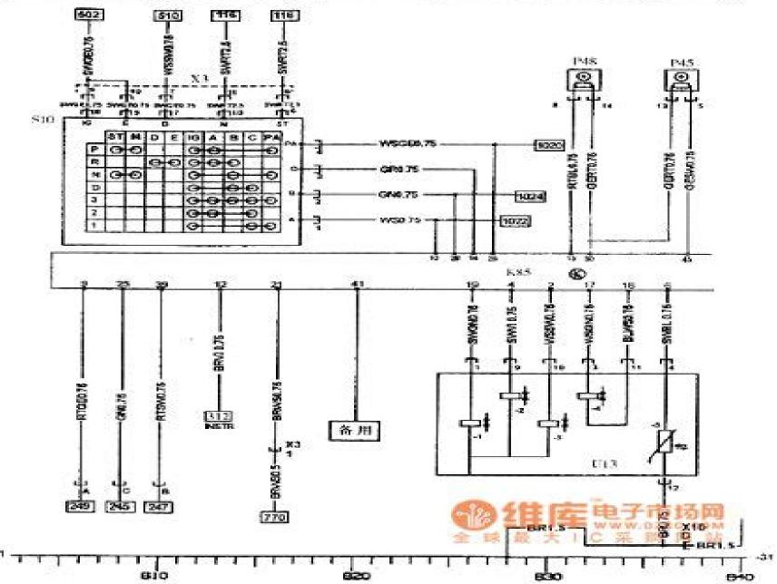
K85-自动变进器电控单元(806~855) P48-变速器输出转速传播器(831~832) S10-換槓杆位置(806-816) P45-变速器输入转速传播器(836-837) U13-解体(826-836)
