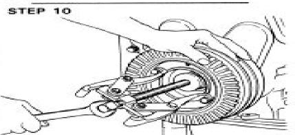
REMOVE THE CRANKSHAFT PULLEY
