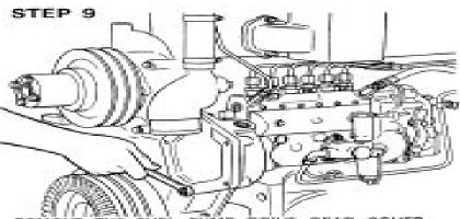
REMOVE THE FUEL PUMP DRIVE GEAR COVER AND REMOVE THE FUEL PUMP, REFER TO SEC-TION 3012 FOR REMOVAL OF FUEL INJECTOR PUMP.
